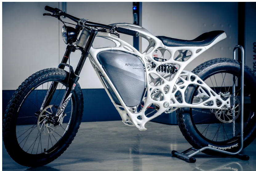
(Cadre d'une moto obtenu à partir d'une optimisation topologique)
